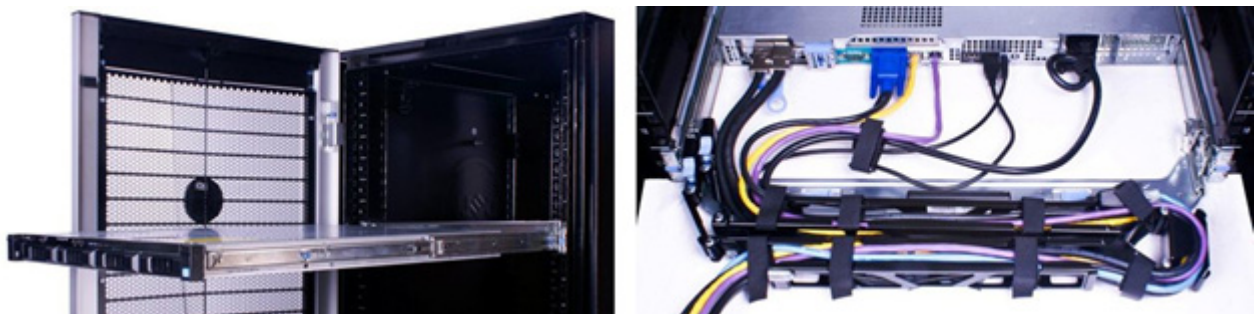
Abbildung 18. In Gleitschienen mit CMA montiertes System
