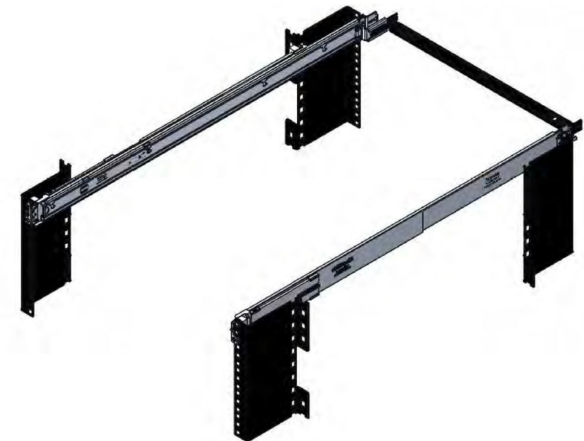
Abbildung 23. Gleitschienen mit optionaler SRB
